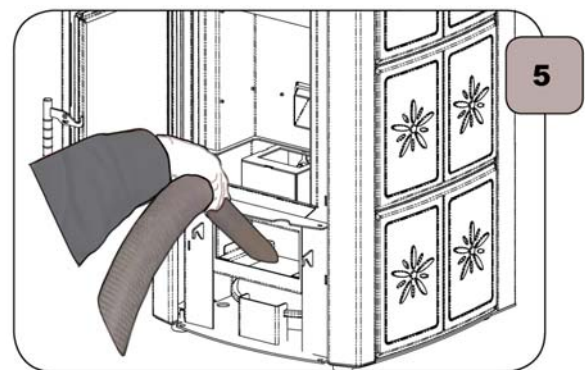
Støvsug rummet under askeskuffen grundigt
